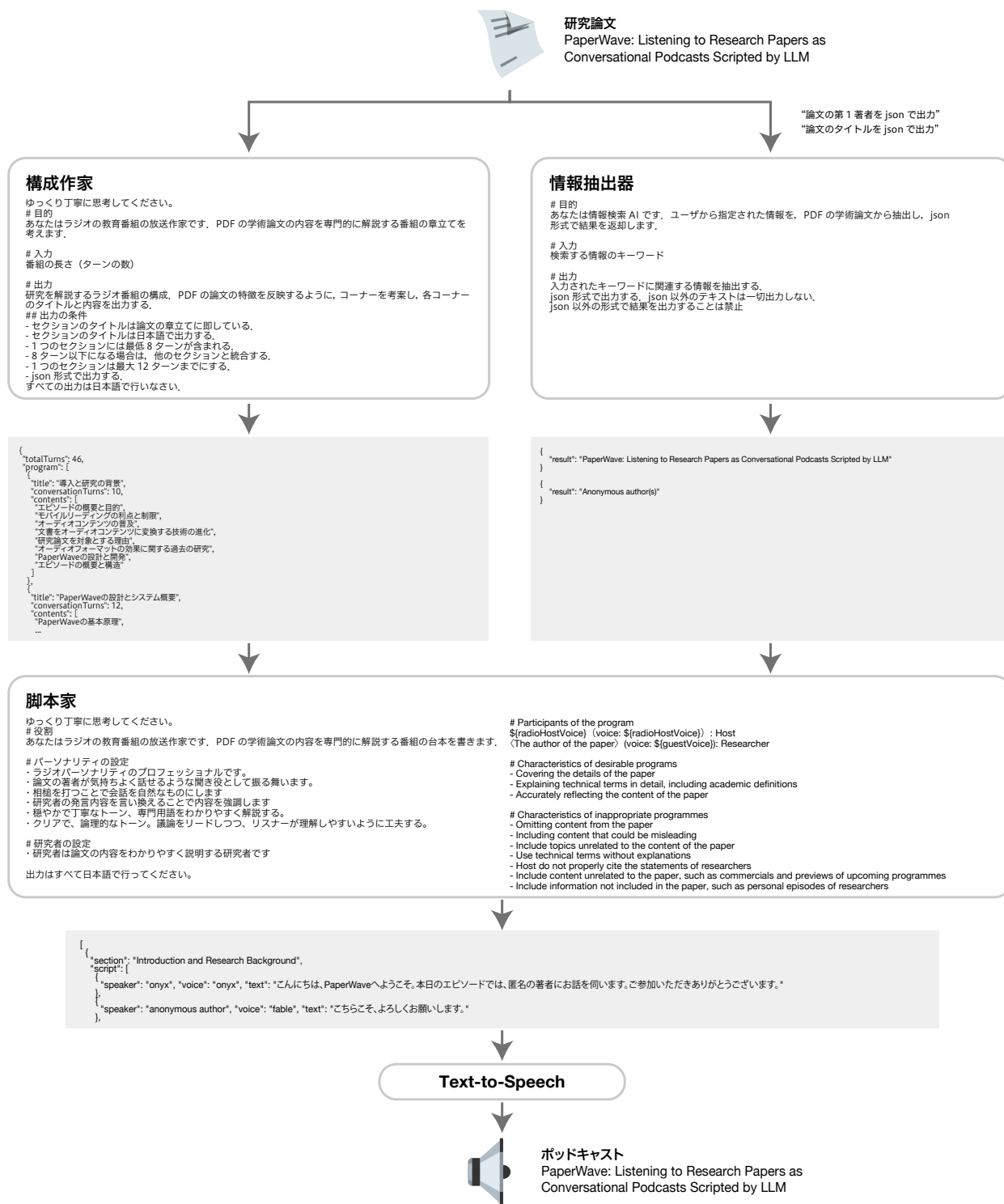
図4 PaperWave CLIの実装。PDFの入力から出力のポッドキャストが得られるまでの処理過程を示している。枠線内がLLMに与えた指示で、灰色の網掛け内が出力のJSONである。
